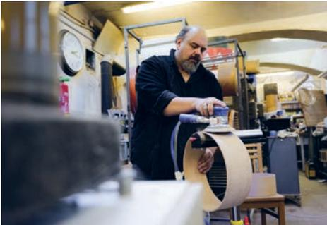
Für die Herstellung von Schichtholzkesseln werden einzelne Furnierlagen in speziellen Formen zu Trommelkesseln verpresst, während die Bretter für die Produktion von Trommeln in Fassbauweise zu schmalen Segmenten (Dauben) aufgeschnitten werden. Im Anschluss daran werden die einzelnen Dauben zu einem Rohkessel verleimt.
