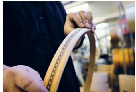
Nach Durchführung diverser weiterer mechanischer Bearbeitungsschritte, sowie Pigmentierung und anschließender Oberflächenversiegelung entsteht ein Trommelkessel, der nach der Montage der entsprechenden Beschlagteile, welche meistens Messing bestehen, das Herzstück des fertigen Instruments darstellt.
