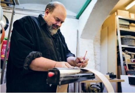
Als Ausgangsmaterial für unsere Instrumente kommt, je nach gewünschtem Konstruktionsprinzip (Schicht- oder Fassbauweise), Furnier in verschiedenen Stärken (meist zwischen 0,6mm und 2mm) oder Schnittholz (massive Bretter oder Bohlen) zur Anwendung. Verarbeitet werden hauptsächlich heimische Hölzer wie Ahorn, Esche, Nuss, Kirsche oder Birke.
